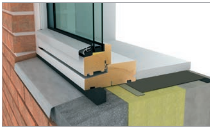
Udvendig fuger udført med illmod 600 fugebånd. Indvendigt lufttæt med DAFAs fugefolier.
